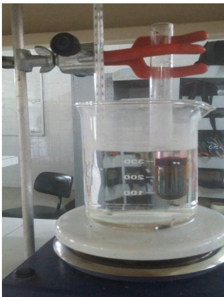
Figura 11. Sistema de aquecimento em banho-maria de água.
